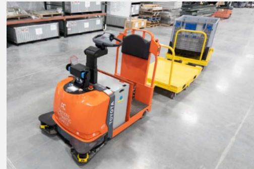
トヨタのけん引車に自動運転機能を搭載 フォークリフト販売店で取り扱い開始
